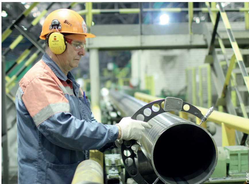
Изготовление труб из стали марки 05ХГБ на ВМЗ
