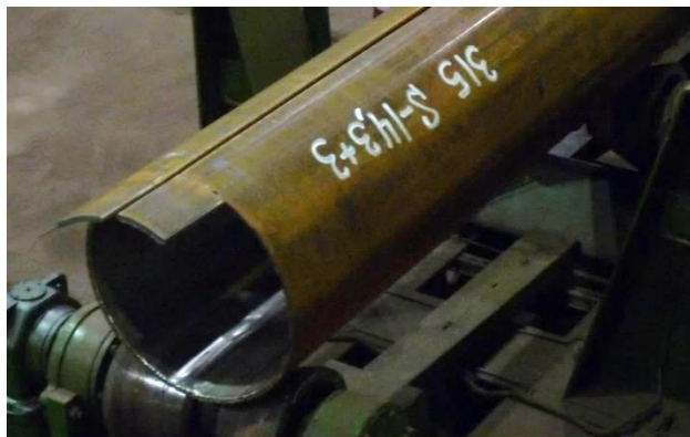
Изготовление опытной партии плакированных труб SAWL на ВМЗ
