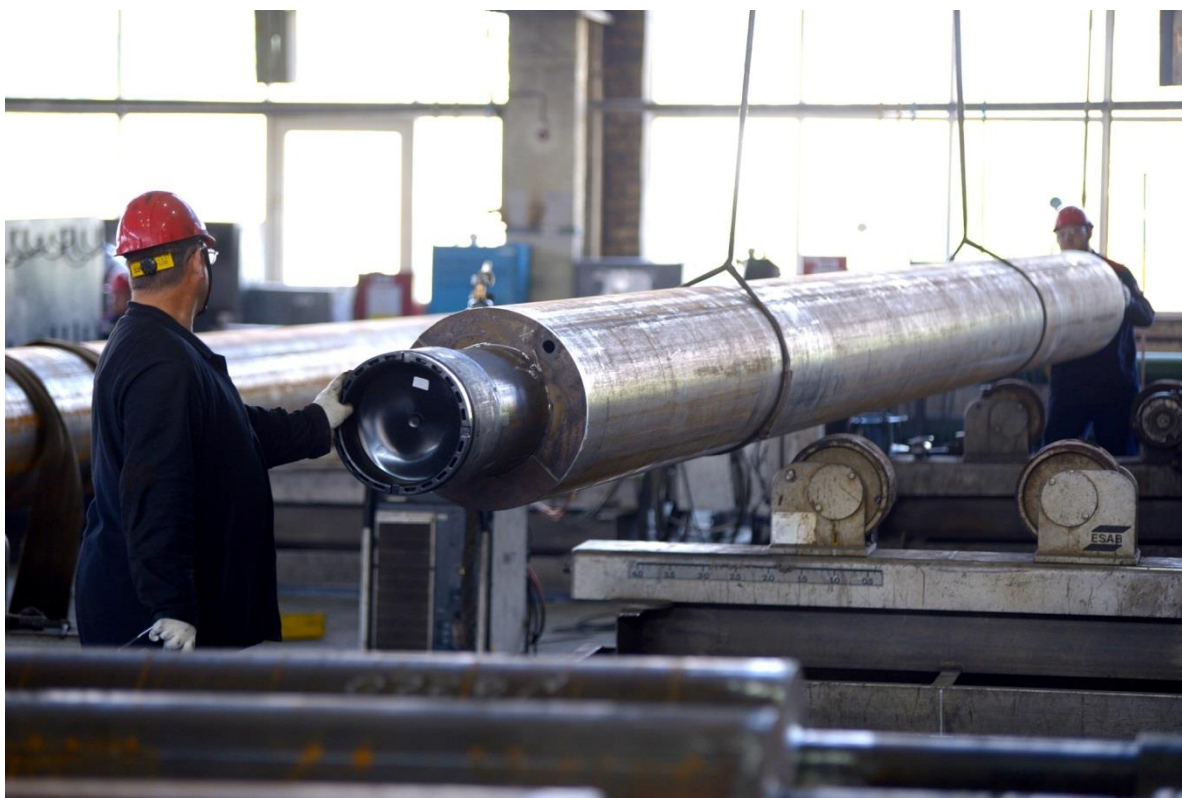
Новая конструкция теплоизолированных обсадных труб (термокейсов) со сварным соединением для работы в условиях вечной мерзлоты от ОМК. Фото: ОМК
