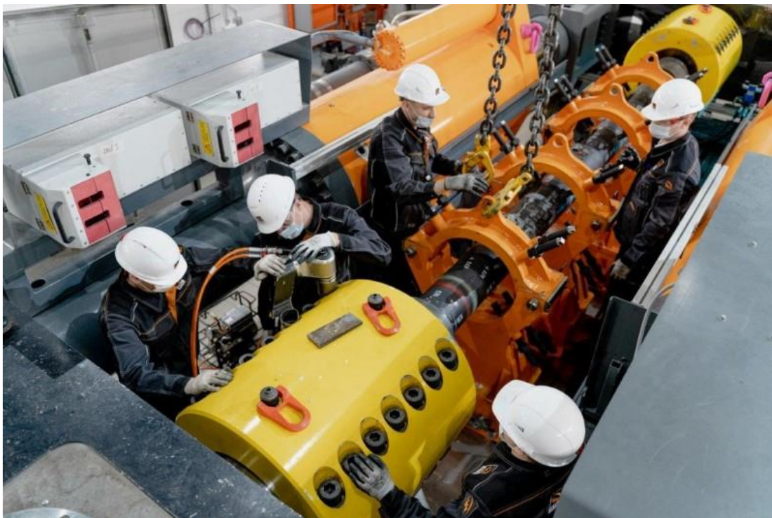
Проведение испытаний соединений ТМК UP CENTUM по международным стандартам ISO. Фото: ТМК
